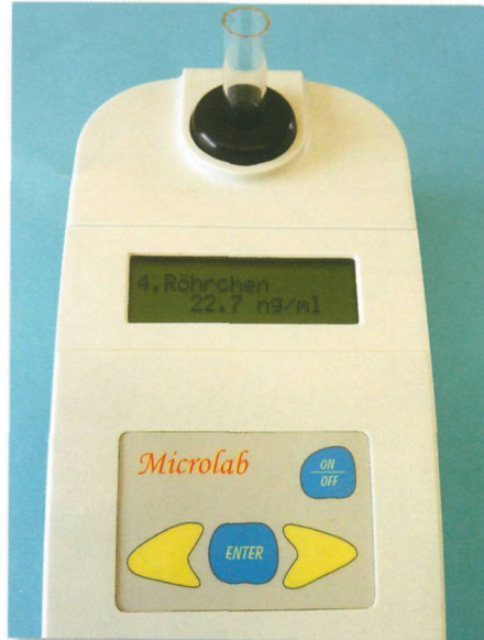
5 pav. Fotometras Microlab Farmertest . Ekranas rodo 22,7 ng/ml (progesteronas nanogramais mililitre) – tai reiškia, kad prieš 3 savaites sėklinta karvė veršinga.
