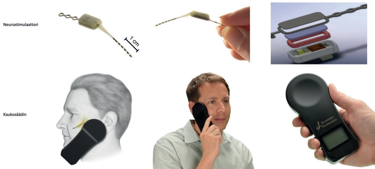
Kuva 4. SPG-stimulaattori (Pulsante®) ja kaukosäädin, millä stimulaattori aktivoidaan.
