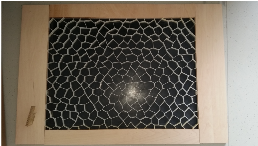
Abb. 7.1: Probe mit Wabenkern und Holzrahmen
