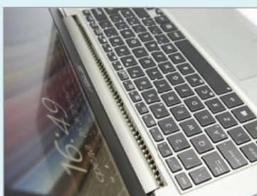
Решетки системы охлаждения спрятаны за шарнирным механизмом.
