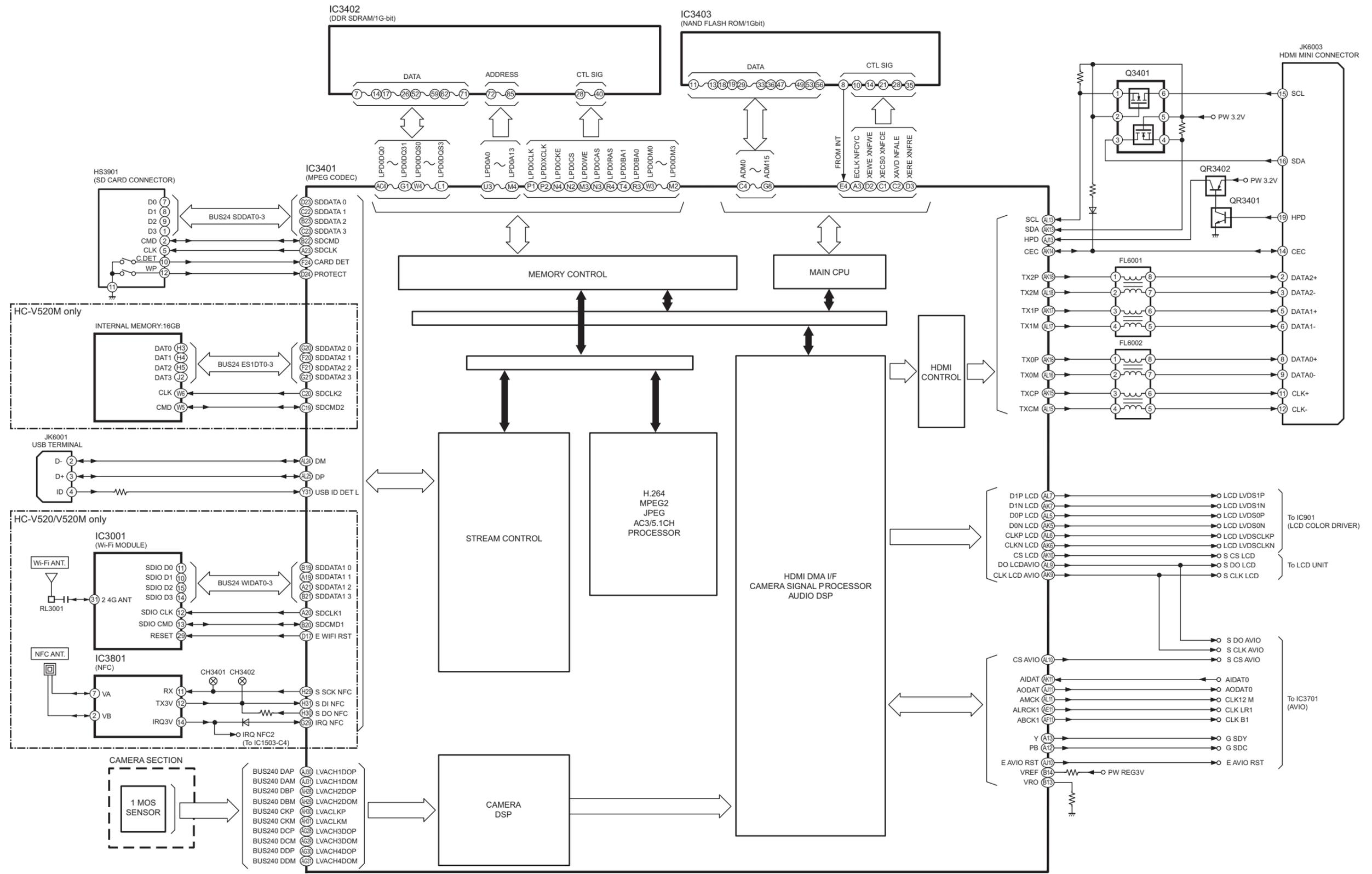
HC-V520/V520M/V510 VIDEO/AUDIO PROCESS(1) CIRCUIT BLOCK DIAGRAM
