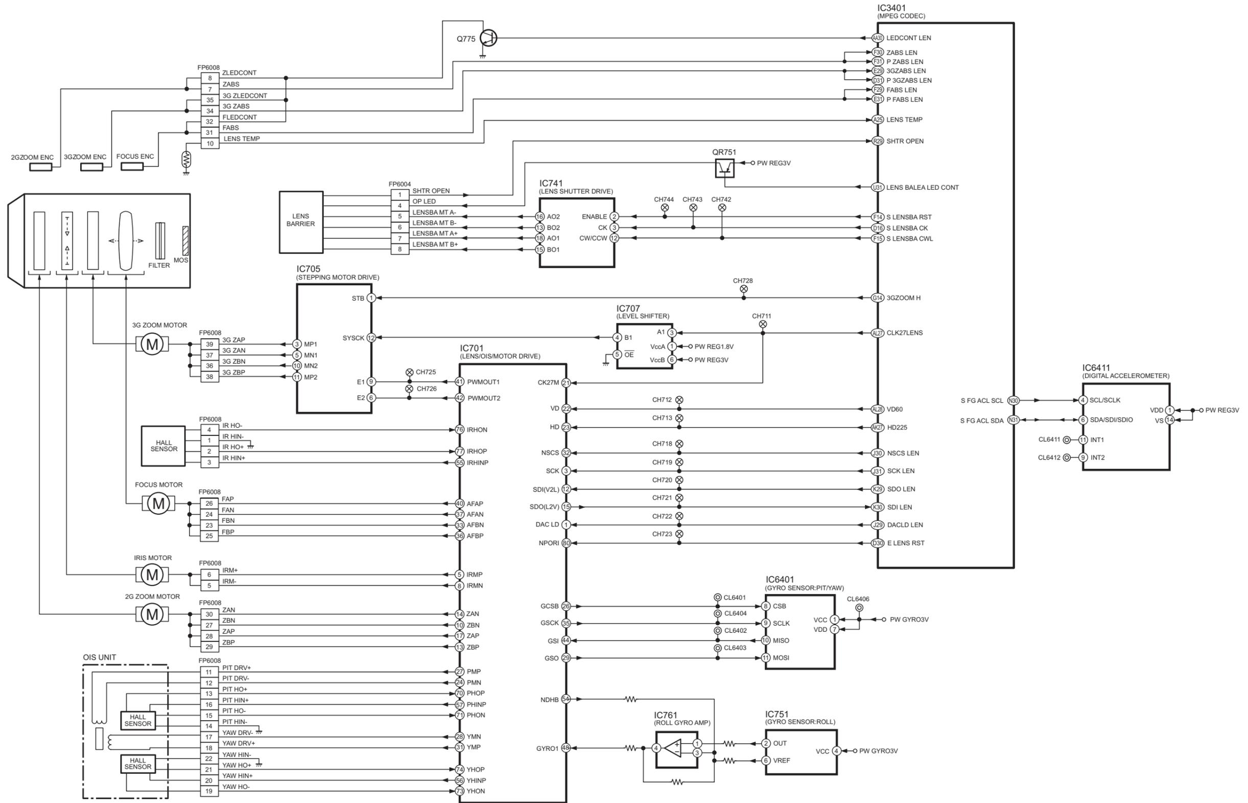
HC-V520/V520M/V510 LENS DRIVE CIRCUIT BLOCK DIAGRAM
