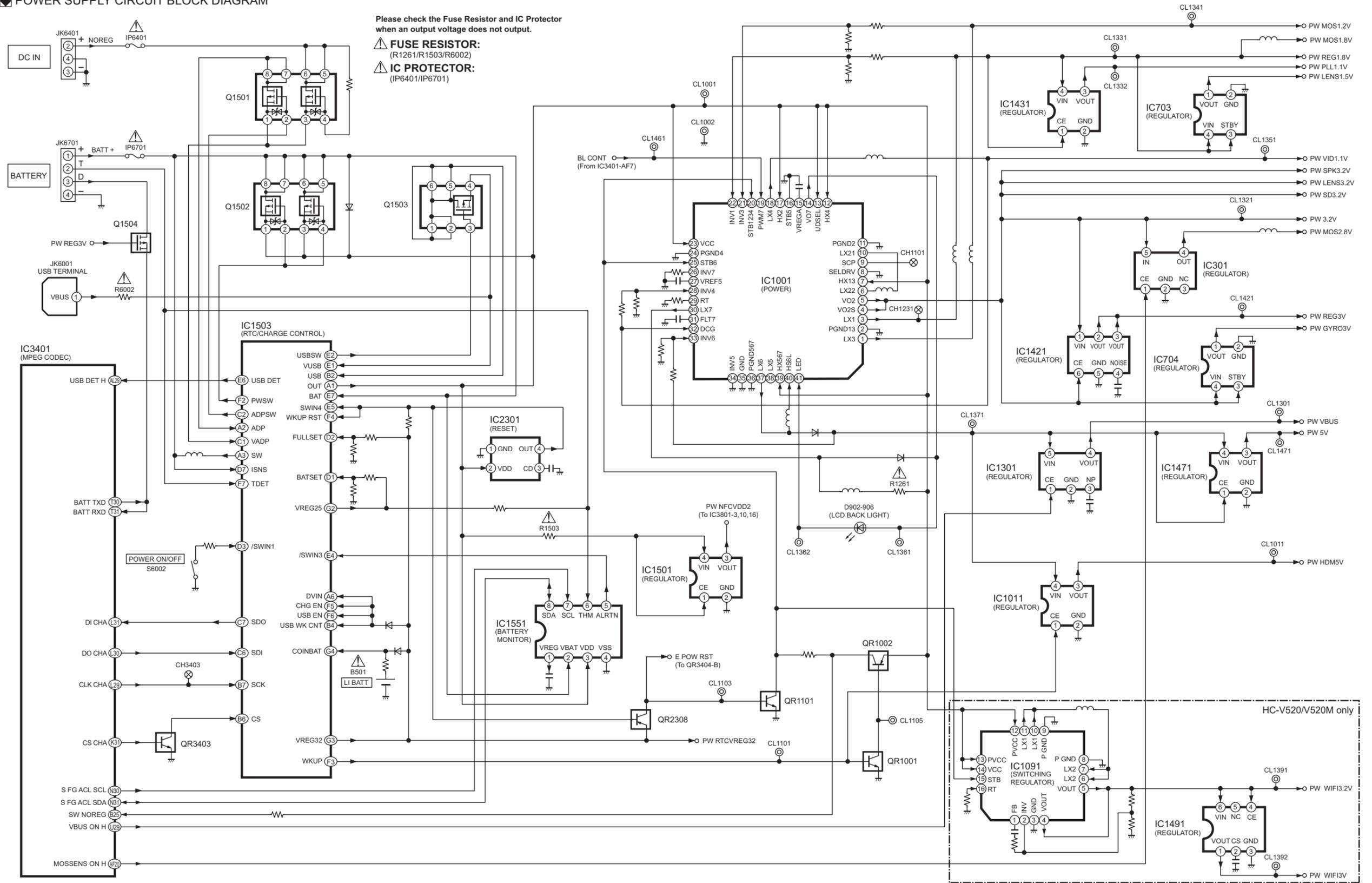
HC-V520/V520M/V510 POWER SUPPLY CIRCUIT BLOCK DIAGRAM
