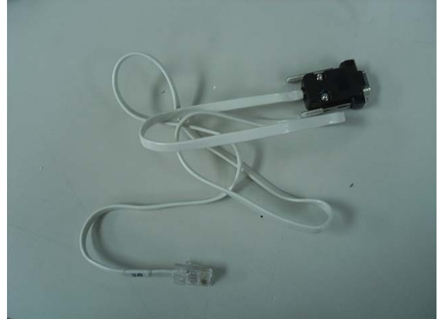
สายต่อ PC Console กับคอมพิวเตอร์แบบ Serial
