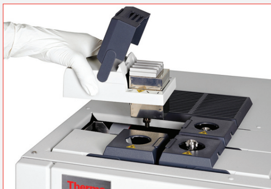
Exemplo de instalação de um módulo de conexão instantânea pelo usuário
