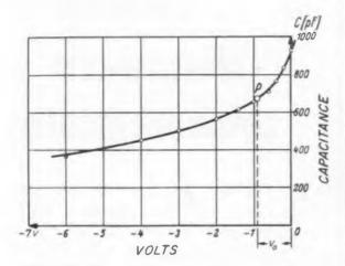
Fig. 2. Zener diode capacitance-voltage
