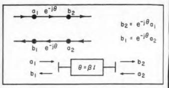
Fig. 1e. Lossless-line length
