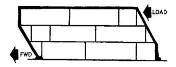
FIGURE A-37. Longitudinal/lateral cargo shift.
