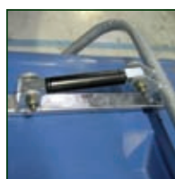
Amortiguación de la tapa mediante cilindro de gas
