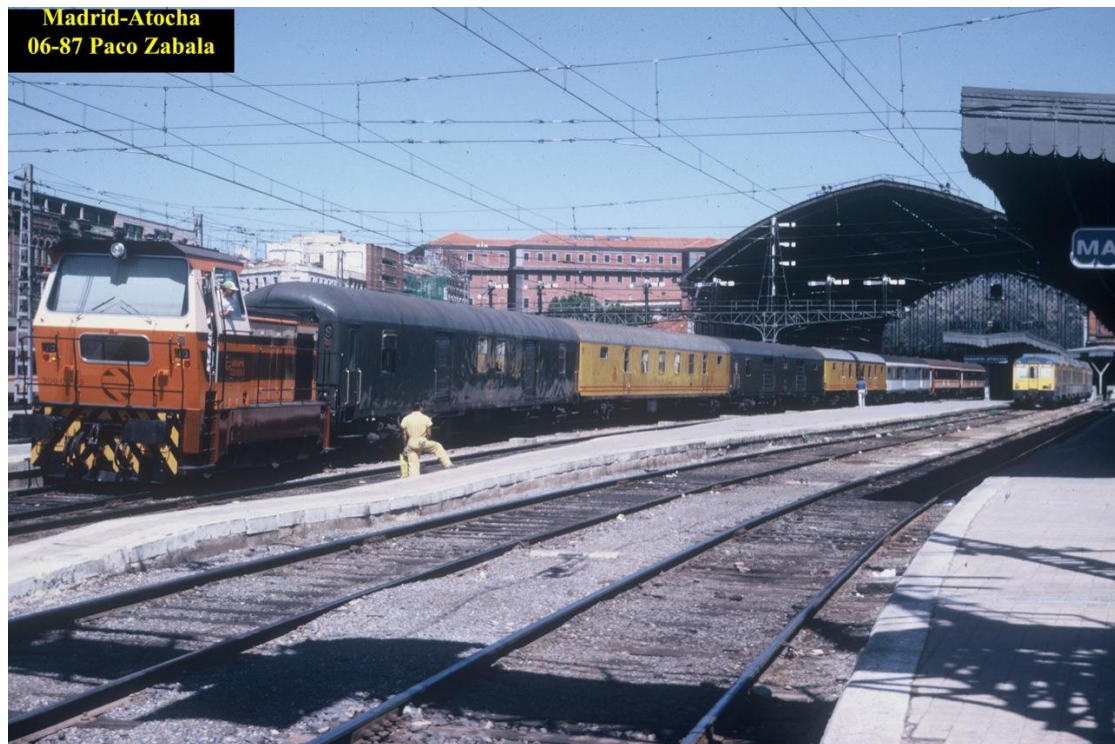
Foto 31.- Maniobras de un tractor 309 con un expreso recién estacionado bajo el Puente de señales de Madrid Atocha. (Foto: Paco Zabala)
