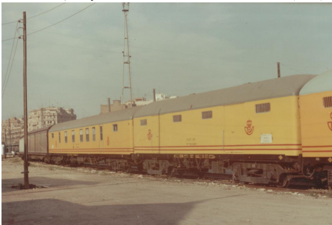
Foto 8.- Composición de la rama de Valencia del Tren Postal Levante (Coche-estafeta DGCT P3-3000 + FP PD 150 + FP PD 10) y otros DDJP 2000. (Foto: Diego Tárraga Vives).
