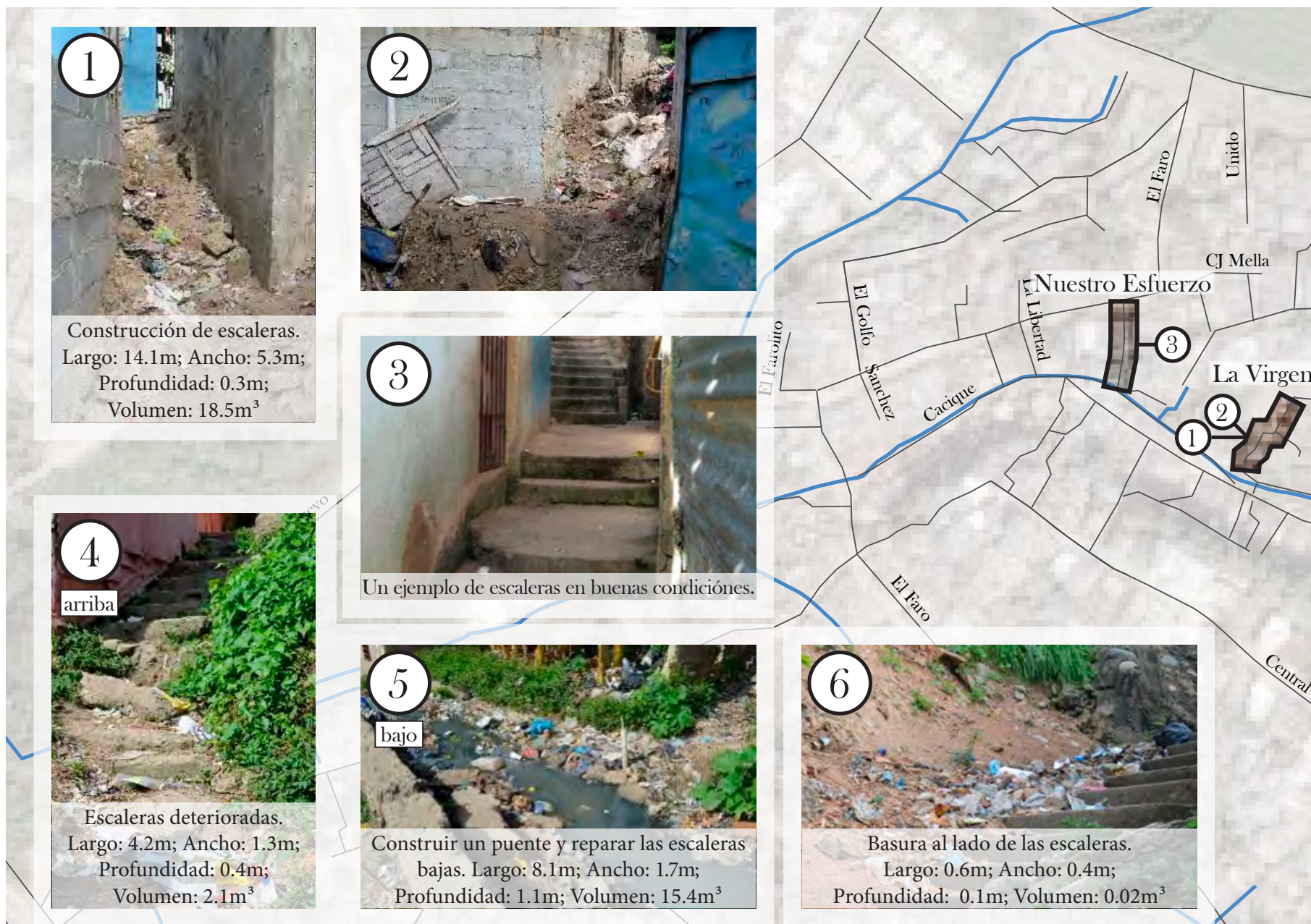
Ilustración 8.9 Reparaciones de escaleras necesarias para facilitar la recogida de la basura doméstica
