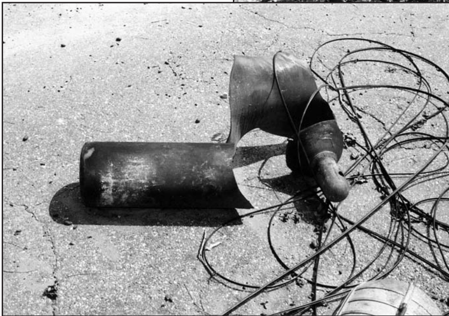
The BLEVE nearly tore acetylene tank in two.
