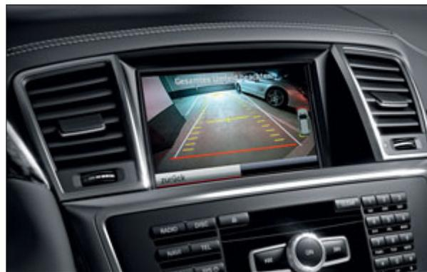
Das zentrale Display des COMAND Online zeigt den Bereich hinter dem Fahrzeug während des Einparkvorgangs mit der Rückfahrkamera.
