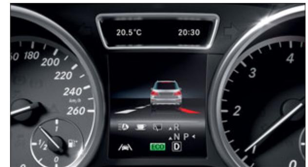
Kann vor ungewolltem Spurwechsel warnen und bei Bedarf korrigierend eingreifen: der Aktive Spurhalte-Assistent.
