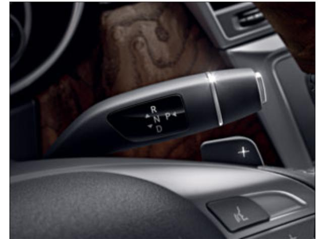
Über den DIRECT SELECT Wählhebel oder die Schaltwippen am Lenkrad kann der Fahrer die Schaltvorgänge beeinflussen.
