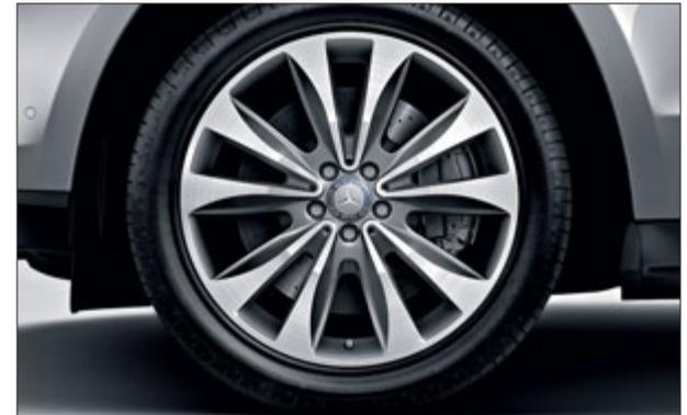
Leichtmetallrad im 10-Speichen-Design mit Bereifung 275/50 R 20, himalayagrau lackiert und glanzgedreht (Option für GL 350 BlueTEC 4MATIC und GL 500 4MATIC, Code 50R).
