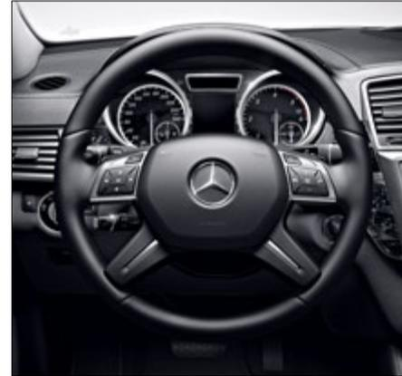
Multifunktionslenkrad in Leder Nappa mit 12 Funktionstasten sowie Lenkradschalt paddles.
