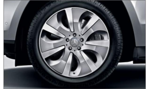
Leichtmetallrad im 7-Speichen-Design mit Bereifung 275/55 R 19, bicolor und glanzgedreht (Option für GL 350 BlueTEC 4MATIC und GL 500 4MATIC, Code 06R).
