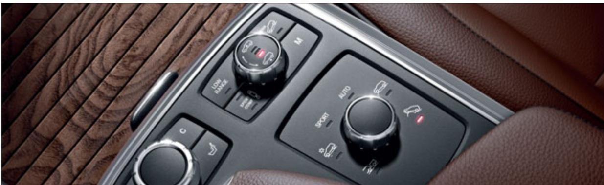
Mit einem Drehschalter auf der Mittelkonsole wird das aktuell gewünschte Fahrprogramm eingestellt.
