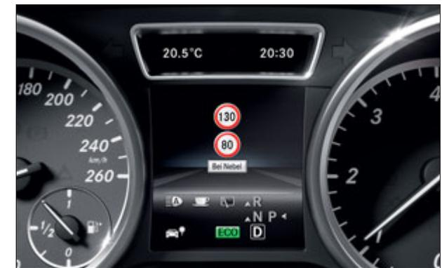
Der Geschwindigkeitslimit-Assistent kann auch temporäre Geschwindigkeitsbeschränkungen im Kombiinstrument anzeigen.
