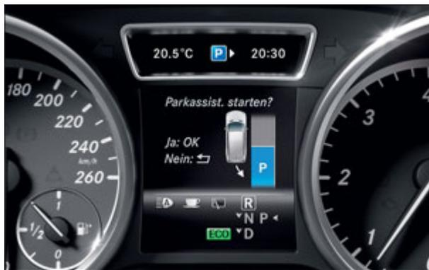
Der automatische Einparkvorgang wird vom System nach maximal fünf Zügen abgeschlossen.
