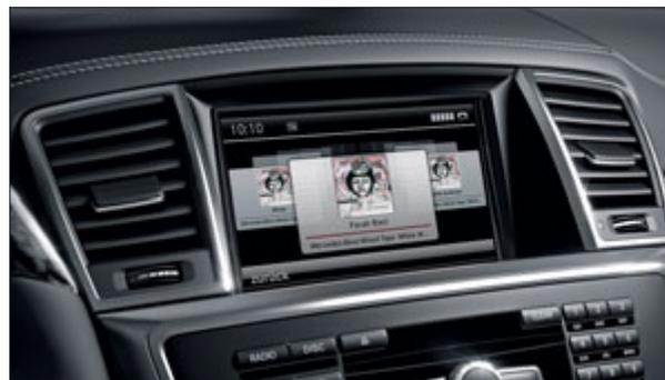
Das Multimedia-System mit Festplatten-Navigationssystem verfügt über ein hochauflösendes Farbdisplay mit einer Diagonale von 17,8 cm.
