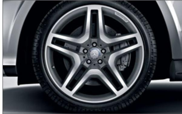
AMG Leichtmetallrad im 5-Doppelspeichen-Design mit Bereifung 295/40 R 21, glanzgedreht (Serie für AMG Sport-Paket Exterior, Code 757).
