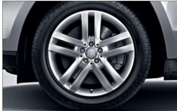
Leichtmetallrad im 5-Doppelspeichen-Design mit Bereifung 275/55 R 19 (Option für GL 350 BlueTEC 4MATIC, Serie für GL 500 4MATIC, Code R55).
