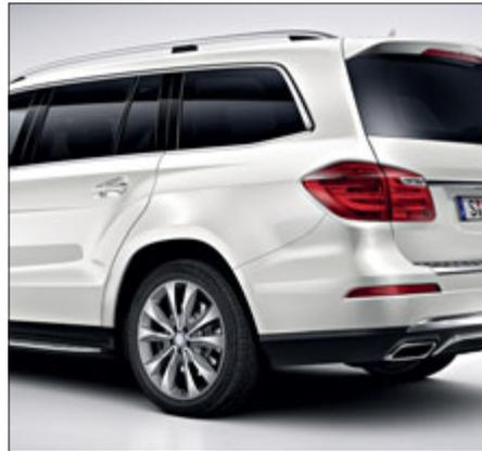
Wärmedämmend dunkel getöntes Glas, rundum ab B-Säule.
