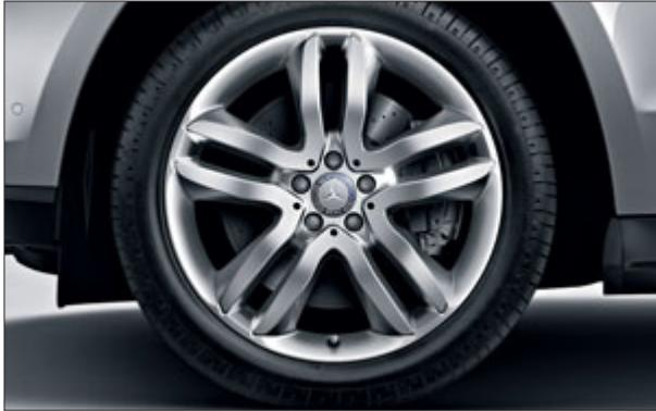
Leichtmetallrad im 5-Doppelspeichen-Design mit Bereifung 275/50 R 20 (Option für GL 350 BlueTEC 4MATIC und GL 500 4MATIC, Code R33).
