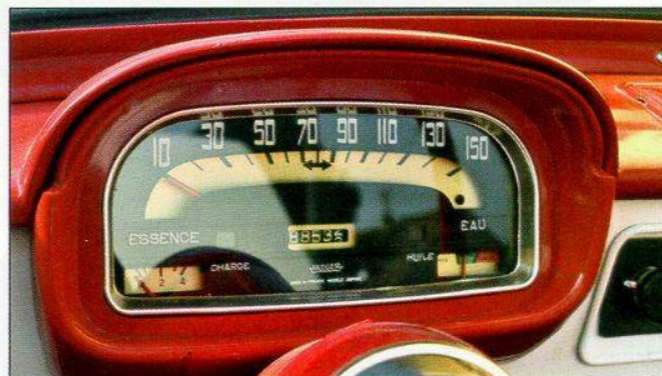
Très lisible, le bloc d'instrumentation est identique à celui de la Dauphine. On regrette toutefois l'absence d'un totalisateur partiel et on notera les marquages qui, au fil des ans, supportent mal la chaleur et se "gondolent" étrangement.
