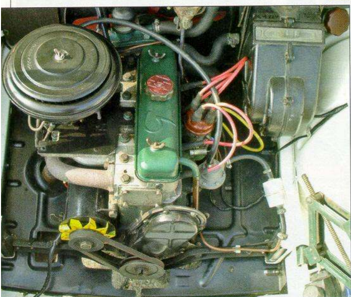
Le petit 845 cm 3 semble un peu perdu sous le capot AR de la Floride ! En contrepartie, l'accessibilité mécanique est royale.
