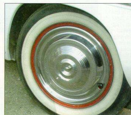
L'enjoliveur de jante est magnifique. Mais il a tendance à tourner lorsqu'il vieillit, coupant alors la valve de la chambre à air. Pour l'éviter, il ne faut surtout pas oublier de monter un centreur de valve.
