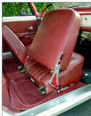
Les sièges se rabattent largement pour laisser l'accès aux places AR. Notez l'élégant compas d'articulation chromé.
