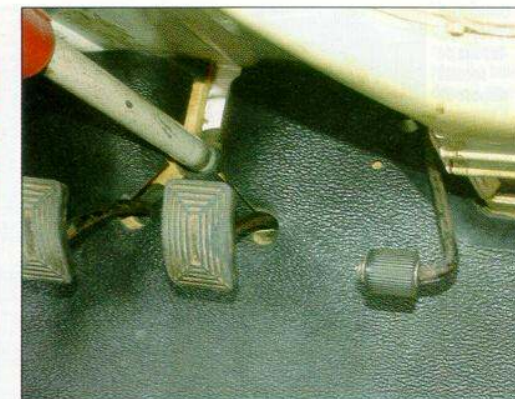
Caractéristique des premiers modèles, la petite roulette de l'accélérateur sera remplacée en octobre 1960 par une pédale plate, articulée au sol.
