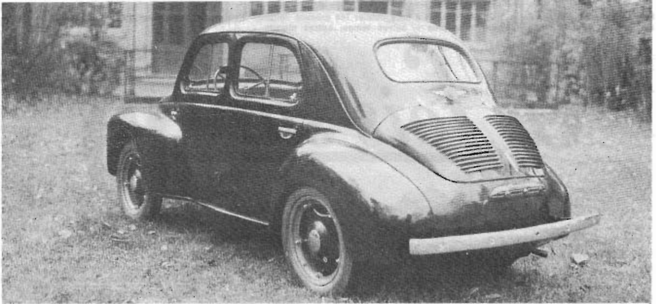
Le prototype n° 3 c'est presque la version définitive hormis la ligne des ailes avant et les roues coplées sur le prototype Simca-Grégoire et qui sont encore très étroites
