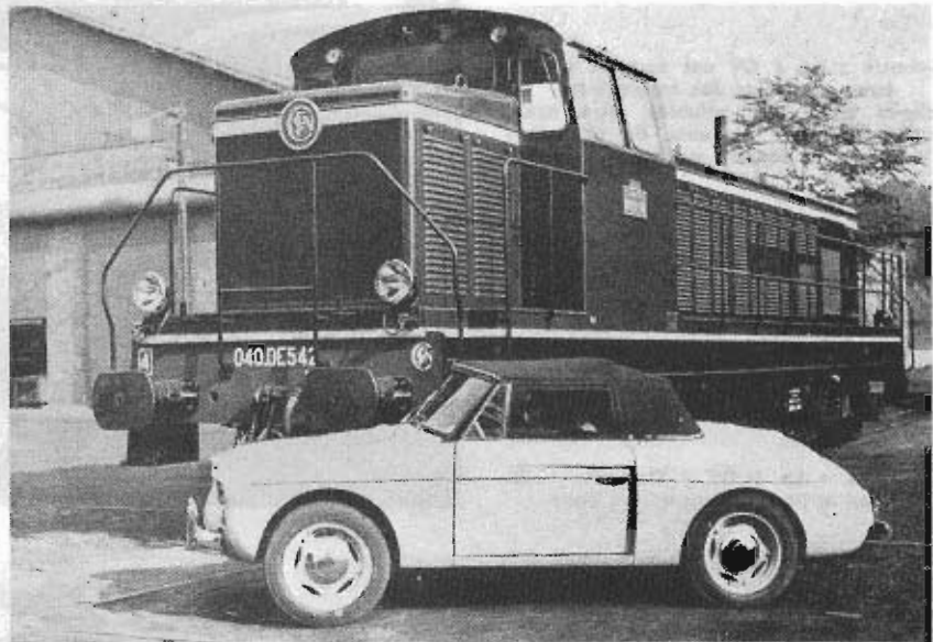
La 4 CV Brissonneau. Créé par Louis Rosier, ce cabriolet à carrosserie en résine armée fut produit en petite série par Brissonneau qui construisait également des locomotives
