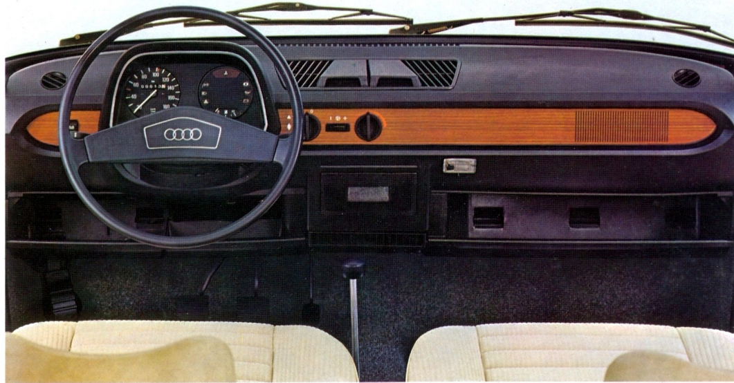
Die umfangreich und übersichtlich ausgestattete Armaturentafel des Audi 50 LS.
