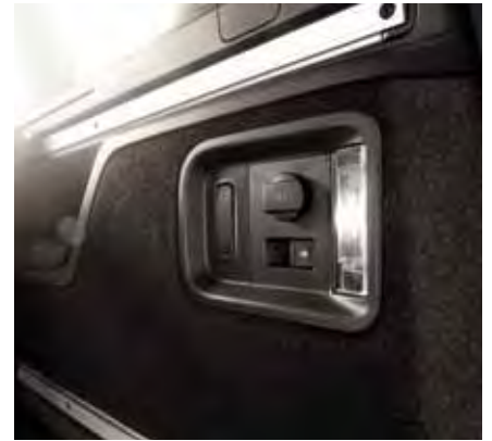
Toma de 12V en maletero y asientos traseros de la segunda fila.
