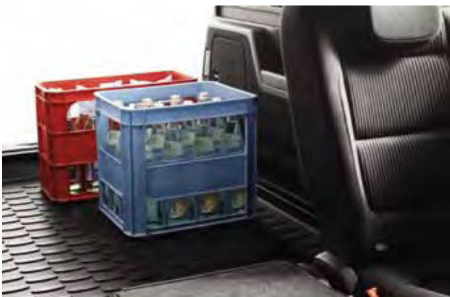
Bandeja protectora de maletero, práctica y resistente, protege con su borde elevado de la suciedad y los líquidos que pudieran derramarse. Es resistente a los ácidos, lavable y antideslizante. 7N5061170
