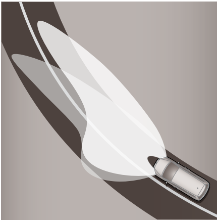
El sistema de iluminación Adaptable (AFS) provee iluminación en los puntos donde más la necesitas, disponible con faros Bixenón.
