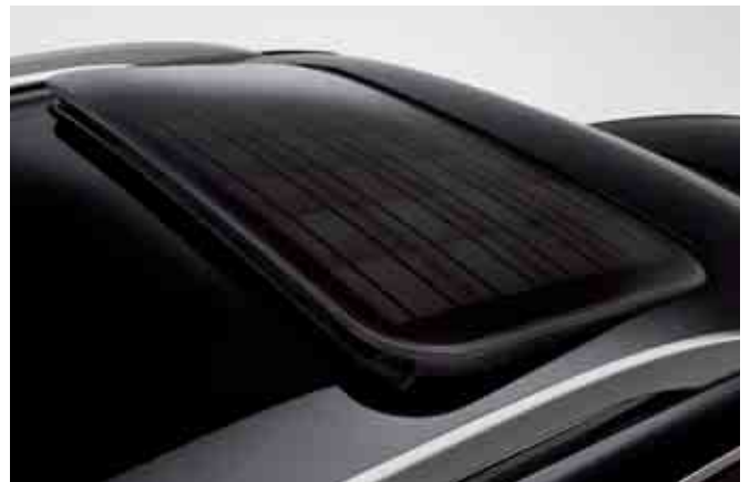
El techo solar genera suficiente energía para recargar la batería del coche y alimentar el sistema de ventilación.
