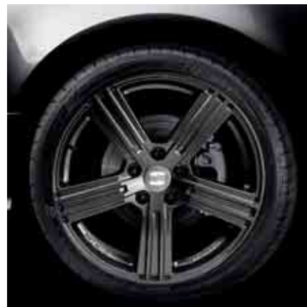
Antracita DV 180: Llanta de aleación ligera de aluminio, 5 radios, color antracita. Tamaño 8 x 18" ET42. 3R0071498
