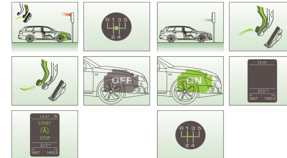
El sistema Start/Stop se activa cuando estás en punto muerto. El motor se apaga y se mantiene parado hasta que pisas embrague.
