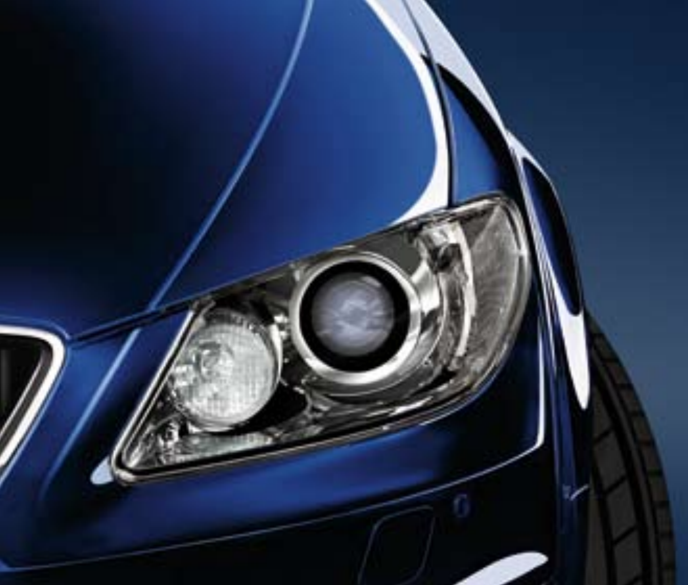
Los faros Bi-Xenon con AFS siguen la dirección del volante iluminando ahí donde más se necesita.
