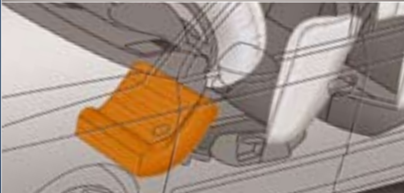
Un airbag para las rodillas protege de forma adicional la parte inferior del conductor.
