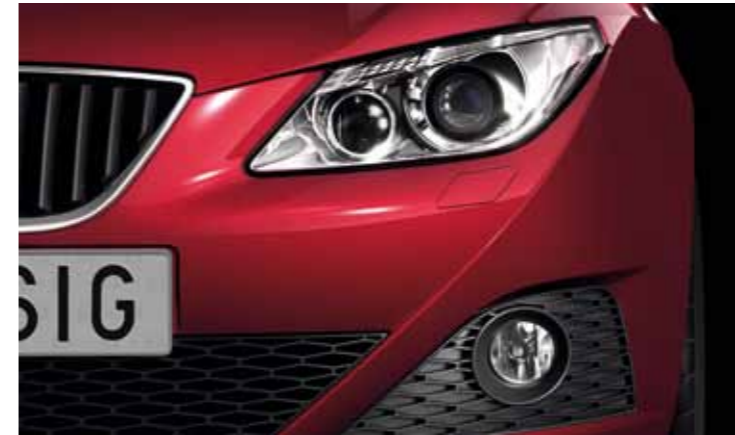
Luces Bixenón que ofrecen una mejor visibilidad en todas sus posiciones (incluye AFS y lavafaros con luz día).
