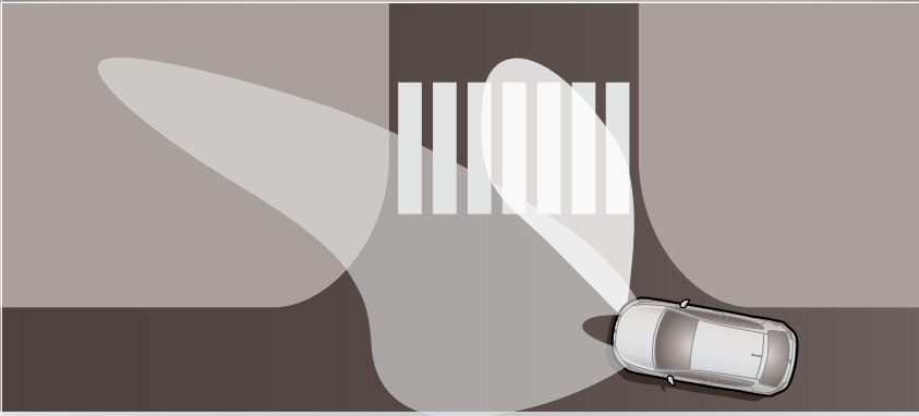
Los faros antiniebla delanteros, con función cornering, enfocan en la dirección a la que se dirige el coche.
