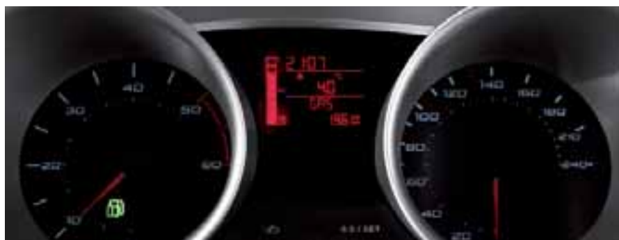
El cuadro de instrumentos dispone de un indicador de nivel específico para cada depósito.
