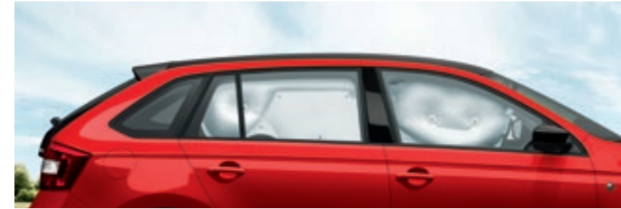
Die Kopfairbags decken nach ihrer Aktivierung den Bereich der Seitenfenster von der A- bis zur C-Säule ab und schützen so die Passagiere.
