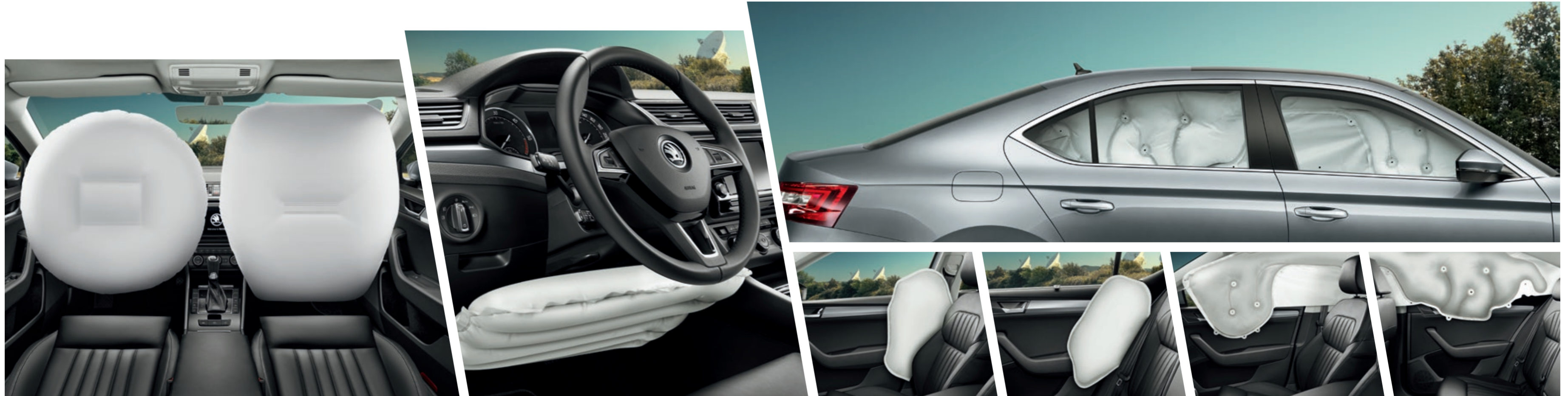
Der Airbag für den Fahrer ist im Lenkrad untergebracht. Der Airbag für den Beifahrersitz befindet sich in der Armaturentafel und kann bei Bedarf abgeschaltet werden, wenn ein Kindersitz angebracht werden soll.
