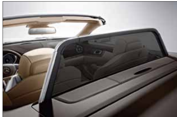
Das elektrische Windschott minimiert Zugluft im Innenraum des geöffneten Fahrzeugs.
