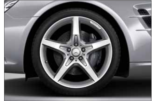
AMG Leichtmetallrad im 5-Speichen-Design, glanzgedreht, mit Bereifung 255/35 R 19 vorne und 285/30 R 19 hinten (Bestandteil AMG Line, Code 770).
