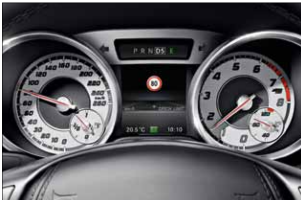
Die Anzeige des Geschwindigkeitslimit-Assistenten erfolgt sowohl im Kombiinstrument als auch im zentralen Display des COMAND Online.
