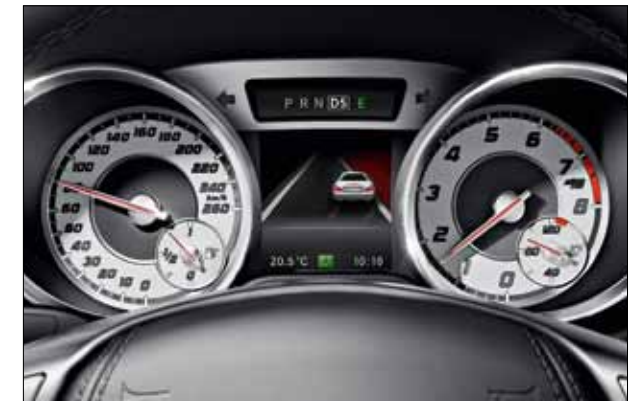
Der Spurhalte-Assistent warnt den Fahrer durch Vibrieren des Lenkrads, wenn sich das Fahrzeug unbeabsichtigt aus der Spur bewegt.
