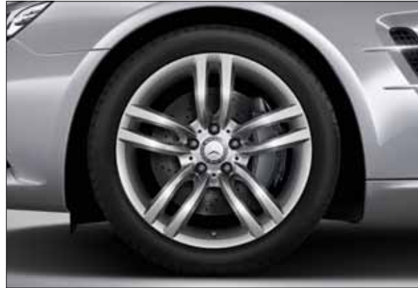
Leichtmetallrad im 5-Doppelspeichen-Design, vanadiumsilber lackiert, mit Bereifung 255/40 R 18 vorne und 285/35 R 18 hinten (optional, Code R70).
