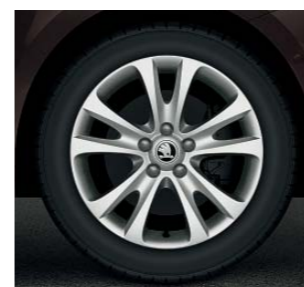
Kola z lehké slitiny Trifid 7,5J x 17" s pneumatikami 225/45 R17
