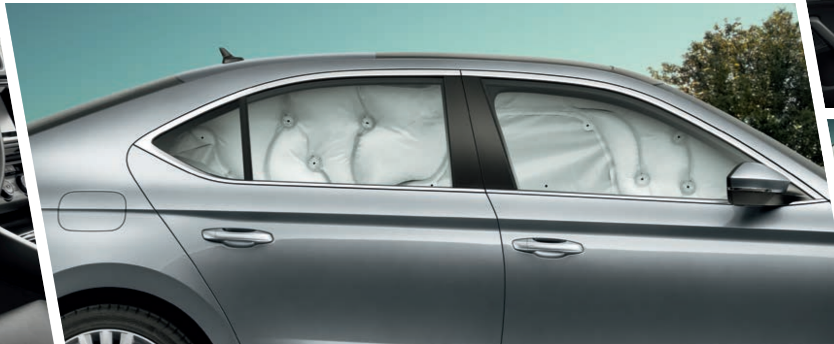
Aktiviert Kopfairbags bilden einen Puffer, der sowohl die vorderen Passagiere als auch die Fahrgäste im Fond vor Kopfverletzungen schützt.
