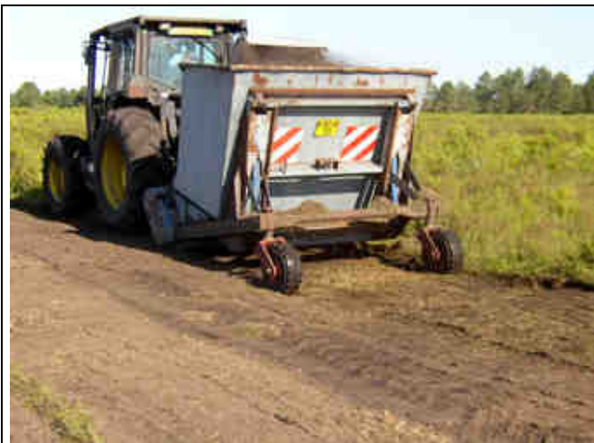
Engin utilisé pour l'étrépage à la zone de saut. Ici traitement d'une lande humide.
