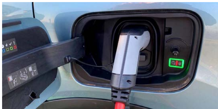
La presa di ricarica accetta sia il Tipo 2 per la AC che il CCS per la DC
