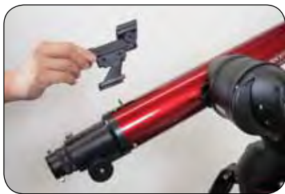
FIGURA 2-13 INSTALLAZIONE DELLO STARPOINTER PER SKYPRODIGY 70
