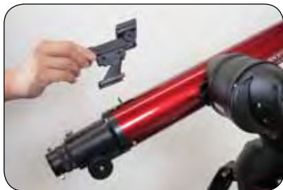
ILLUSTRATION 2-13 INSTALLER LE STARPOINTER POUR SKYPRODIGY 70
