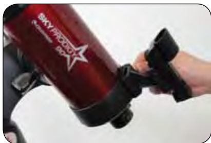
FIGURA 2-14 INSTALAR EL STARPOINTER PARA SKYPRODIGY 90 Y 130
