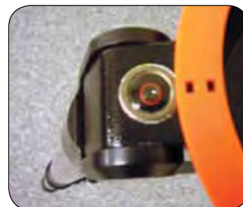
ILLUSTRATION 2-2 Mettre le trépied à niveau
