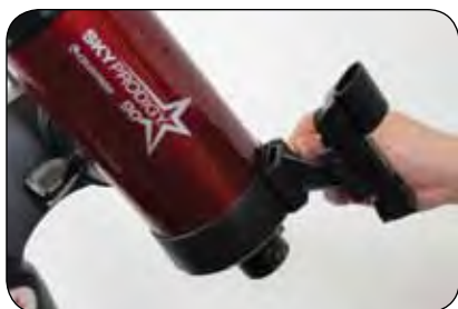
ILLUSTRATION 2-14 INSTALLER LE STARPOINTER POUR SKYPRODIGY 90 & 130
