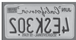
Inversé horizontalement, tel que vu au travers de la diagonale en étoile
