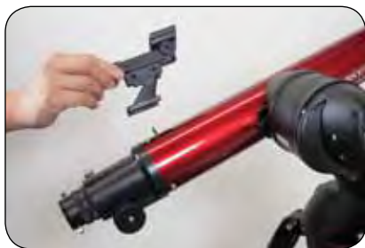
FIGURA 2-13 INSTALAR EL STARPOINTER PARA SKYPRODIGY 70
