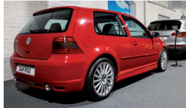
2002 Volkswagen Golf R32 je najvýkonnejší variant modelu Golf. Pod kapotou má 3,2-litrový šesťvalec VR6. Bol to prvý model VW vybavený DSG prevodovkou. Vďaka výkonu 177 kW (241 k) a pohonu 4MOTION dokázal zrýchliť z 0 na 100 km/h za 6,6 sekundy.
