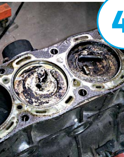
Masívne poškodenie piestov spôsobené zvýšeným „klepaním“ motora
