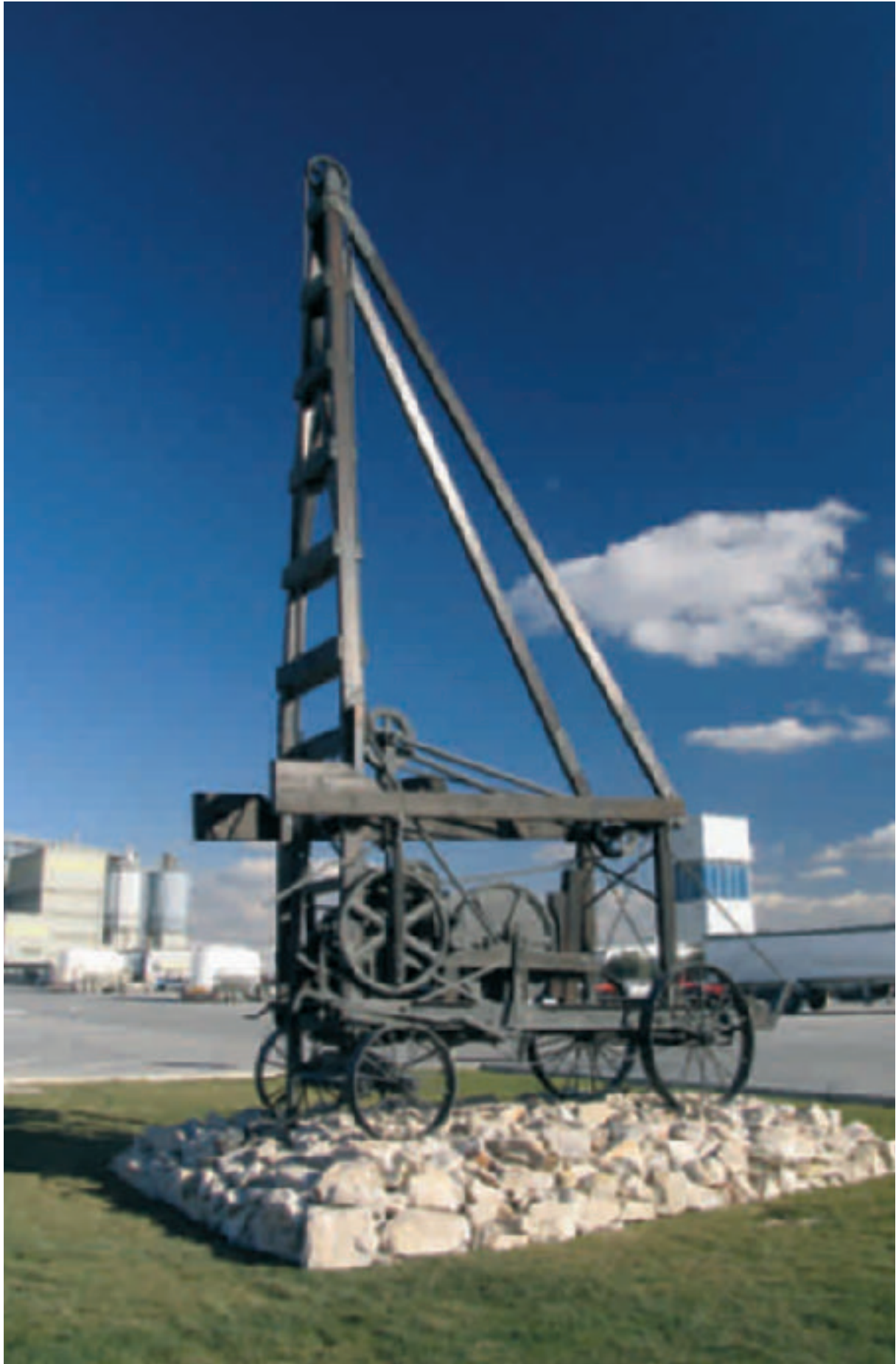
Fábrica de El Alto: perforadora Keystone, fabricada en 1912.
