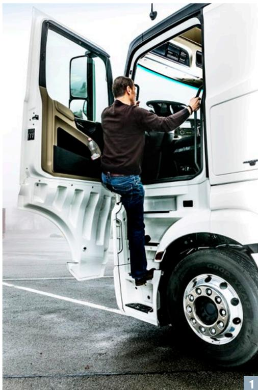
**1 IN DIE ACTROS-KABINEN** mit ebenem Boden (Stream, Big und Giga Space) führen vier Stufen.
