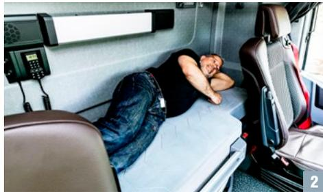
**2 MIT EINEM AUSZUGSMECHANISMUS** kommt das untere Bett auf maximal 78 Zentimeter Breite. Die Kabelfernbedienung an der Rückwand bietet Funktionen für Innenbeleuchtung, Radio, Telefon, Standheizung, Klimaanlage, Türverriegelung, Fensterheber und Dachluke.
