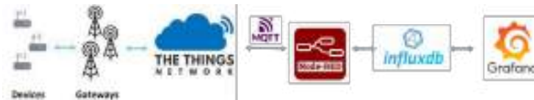
Fig. 6. Esquema general de transmisión y registro de datos.
