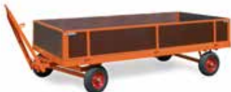
Beispiel: Schwerlast-Industrieanhänger, 1-Achs-Drehschemellenkung mit 4 Bordwänden
