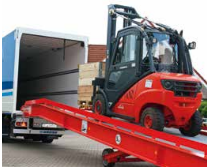
Abb.: Verladeplattform mit Überladebrücke zur Flächenerweiterung zwischen Fahrzeug und Rampe.
