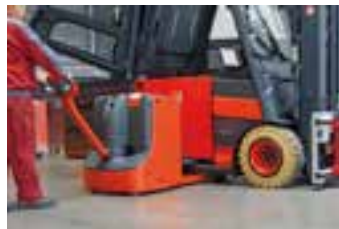
Schritt 2: Batterie mit dem Hubwagen ROTABATT 80 V herausfahren
