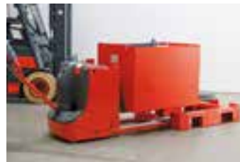
Schritt 3: Entnommene Batterie auf der Plattform absetzen
