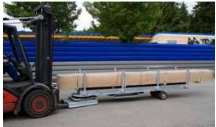
Abb.: Durch Gabelstaplertaschen kann der Langguttransportwagen je nach Gewicht mit Schlepper oder Gabelstapler bewegt werden.
