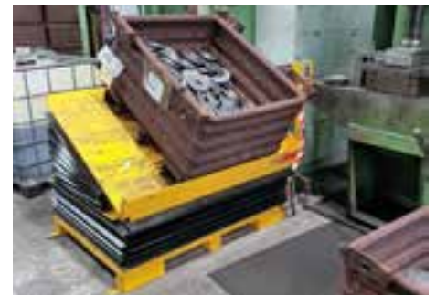
Abb.: Pneumatisches Hub-Neigegerät als Stand-alone-Gerät oder zur Montage auf Drehplattformen
