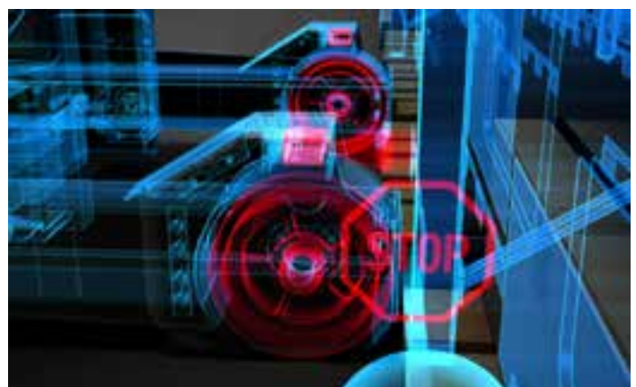
Abb.: Der Regalanfahrerschutz Rack Protection Sensor (RPS) von Linde erkennt durch zwei Lichtsensoren automatisch Hindernisse beim Manövrieren am Regal und bremst den Stapler dynamisch ab.
