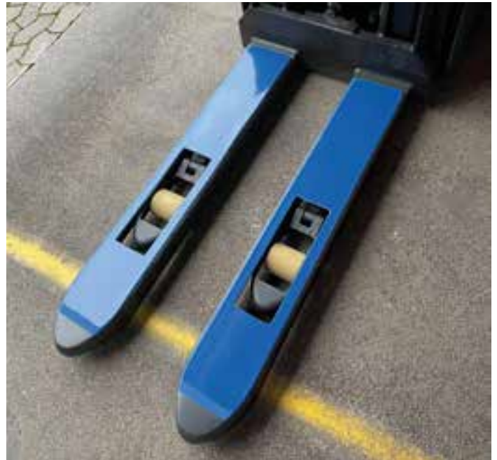
Abb.: Lebensmittelgerechte Gabelzinkenbeschichtung
