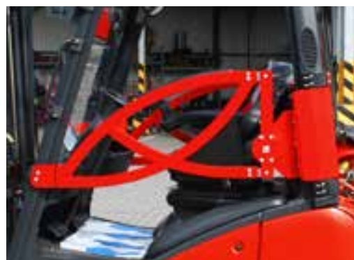
Abb.: Beim SRS (links) öffnen und schließen beide Bügel wie eine Tür, beim SRS CONCEPT (rechts) schwenkt der linke Bügel beim Öffnen nach oben
