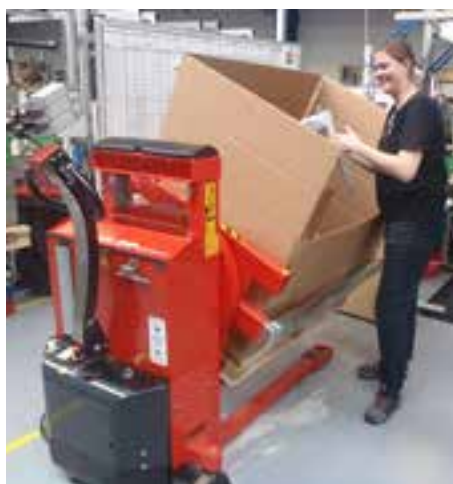
Optimale Ergonomie: Der Anwender kann den Inhalt erreichen, ohne sich strecken zu müssen.
