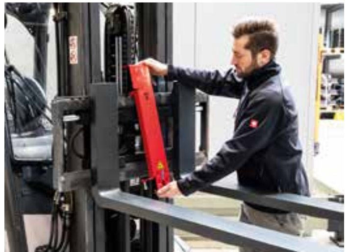
Abb.: Schnelle, nachträgliche Montage am Gabelträger
