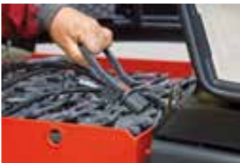
Schritt 1: Stecker der Batterie abziehen
