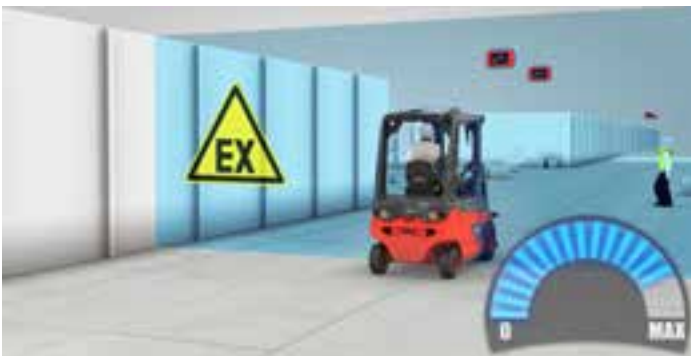
Abb.: Das Assistenzsystem Linde Safety Guard ist jetzt auch für Ex-geschützte Flurförderzeuge der ATEX-Zonen 2/22 verfügbar. Es bremst Fahrzeuge automatisch ab, wenn sie sich zu nahe kommen oder in einen vorher definierten Bereich einfahren.
