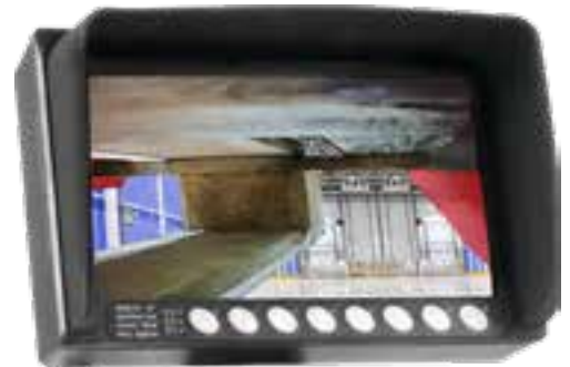
Abb.: Verbesserte Sicht der integrierten Grip-View-Kamera (Gabelzinken rot eingefärbt)
