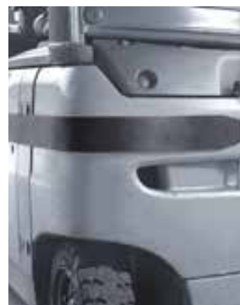
Abb.: Auch als Rammschutz für das Stapler-Chassis verwendbar
