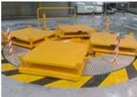
Anwendungsbeispiel: 4 x 90° Luftkissen-Drehplattform mit Aufnahmen für Ladungsträger
