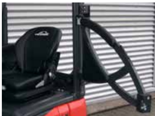
Abb.: Beim SRS (links) öffnen und schließen beide Bügel wie eine Tür, beim SRS CONCEPT (rechts) schwenkt der linke Bügel beim Öffnen nach oben
