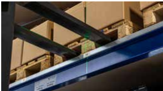
Abb.: Anvisieren von Ladungsträgern mit Kreuzlaser
