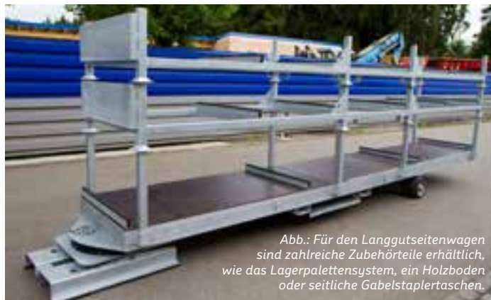
Abb.: Durch Gabelstaplertaschen kann der Langguttransportwagen je nach Gewicht mit Schlepper oder Gabelstapler bewegt werden.
