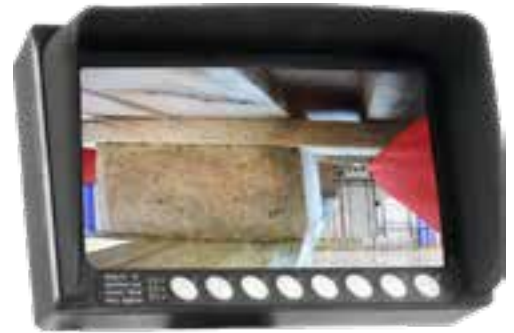
Abb.: Eingeschränkte Sicht mit angebauter Kamera. Marktstandard (Gabelzinken rot eingefärbt)
