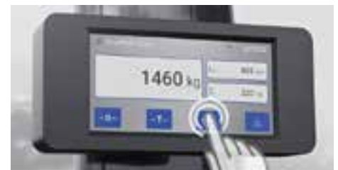
Abb.: SmartFork® Scale Display mit Lastschwerpunkt-Anzeige
