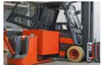
Schritt 4: Die geladene Ersatzbatterie mit dem Hubwagen ROTABATT 80 V einfahren
