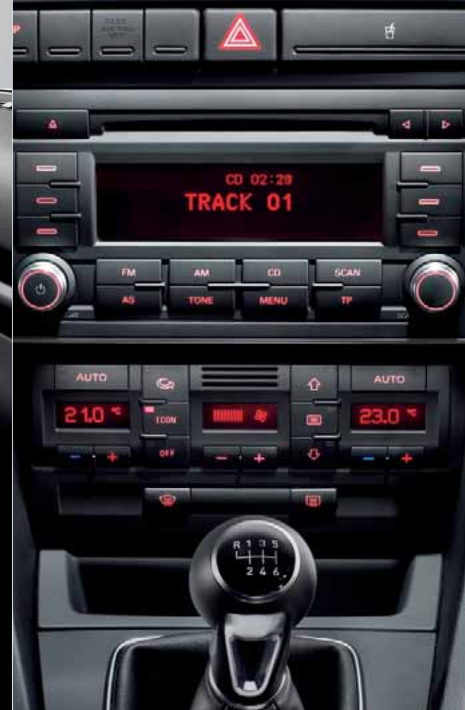
Le système de climatisation Climatronix bizona régule les températures pour le conducteur et les passagers.
