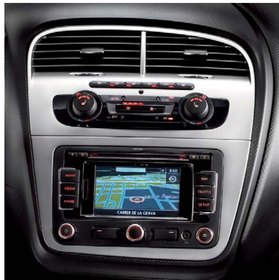
GPS RNS 315, cartographie Europe de l'ouest, écran couleur tactile + système Bluetooth® pour téléphone portable.
