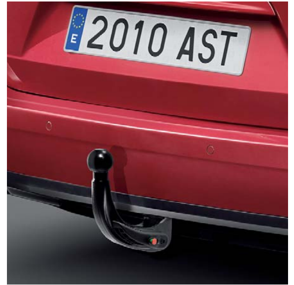
Attelage à rotule démontable sans outils.
