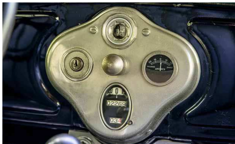
MOLLEGGIATO Sopra, il comodo sedile posteriore ben imbottito e molleggiato. A sinistra, il quadretto centrale con chiave di accensione a sinistra, indicatore benzina in alto, luce cruscotto al centro, contachilometri sotto e amperometro a destra.
