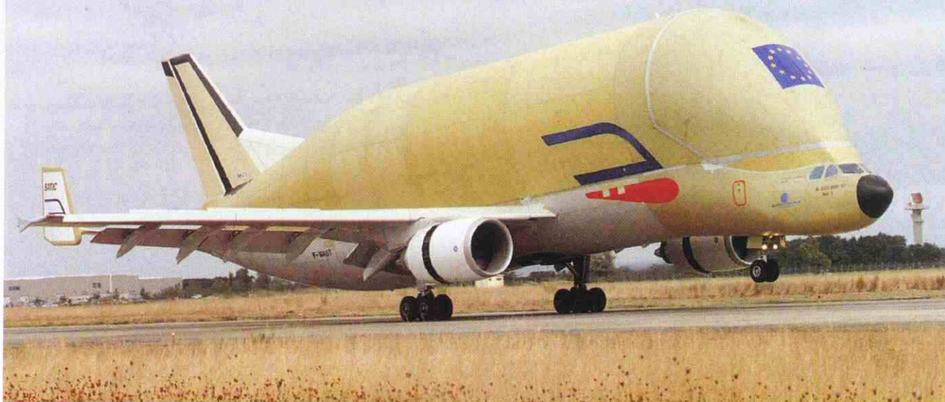
El Super Air Transport (SAT) "Belouga" (ballena), nº 1, que hizo su primer vuelo de servicio el 9 de octubre de 1995, transportando de Bremen a Toulouse un conjunto de ala completa (dos semialas con sus herrajes de encastre), de un A 340 para entrega a China Eastern Airlines. El peso de la carga transportada fue de 42'5 Tm, siendo la máxima carga potencial de 45'5 TM.
