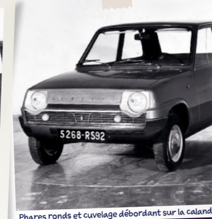
Phares ronds et cuvelage débordant sur la calandre.
