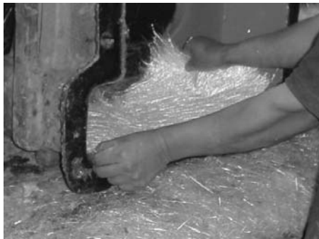
Colocacion de fibra sobre el molde
