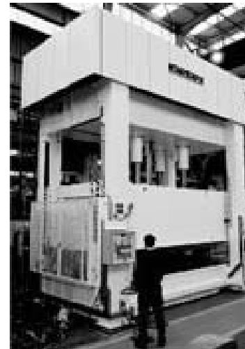
Prensa hidráulica para moldeado por compresión de plásticos de 4000 kN de simple efecto superior.
