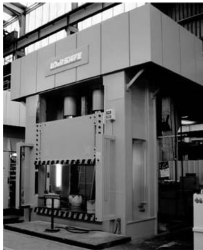
Prensa hidráulica para moldeado por compresión de plásticos de 6000 kN de simple efecto superior.
