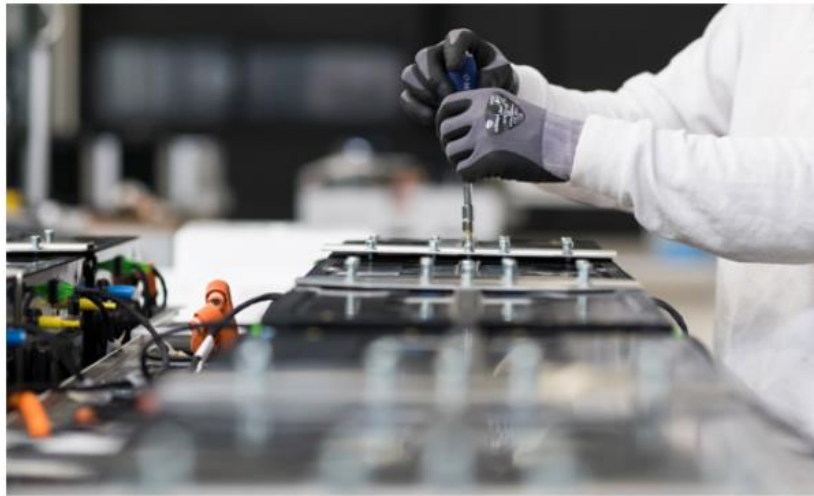
Figura 59: Construcción del pack de baterías. (Irizar Group, 2019)
