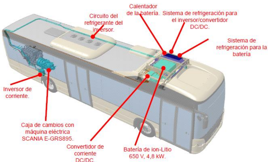
Figura 49: Cadena Cinemática Scania Citywide Híbrido. (Scania, 2017)
