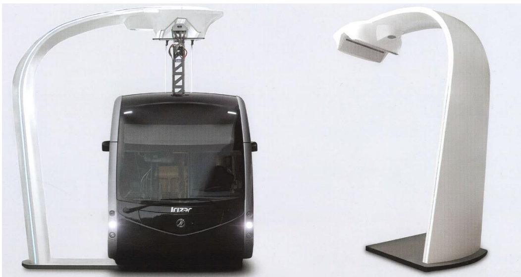
Figura 68: Irizar ie tram conectado al pantógrafo. (Irizar Group, 2018)
