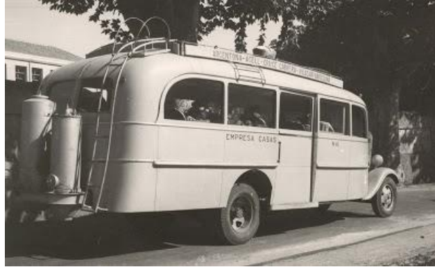
Figura 7: Autobús español convertido a gasógeno. (Fernandez Valentí, 2012)
