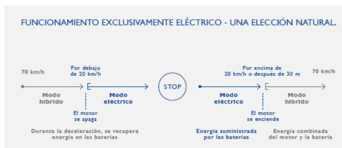
Figura 22: Funcionamiento del sistema "Arrive & Go". (Iveco, 2017)
