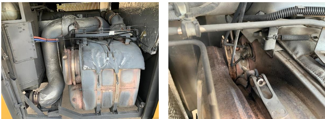
Figura 15 y Figura 16: Catalizador incorporado en el escape (i) y uno de los inyectores del sistema de AdBlue (d) en un motor Volvo Euro 6 (Elaboración propia)
