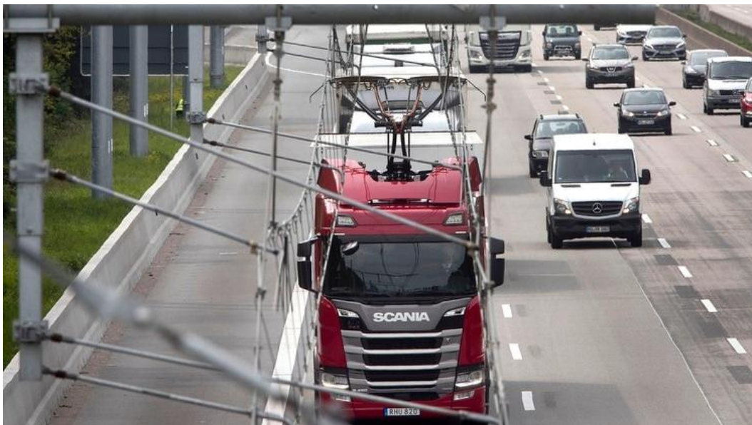
Figura 55: Detalle pantógrafo. (El País, 2019)
