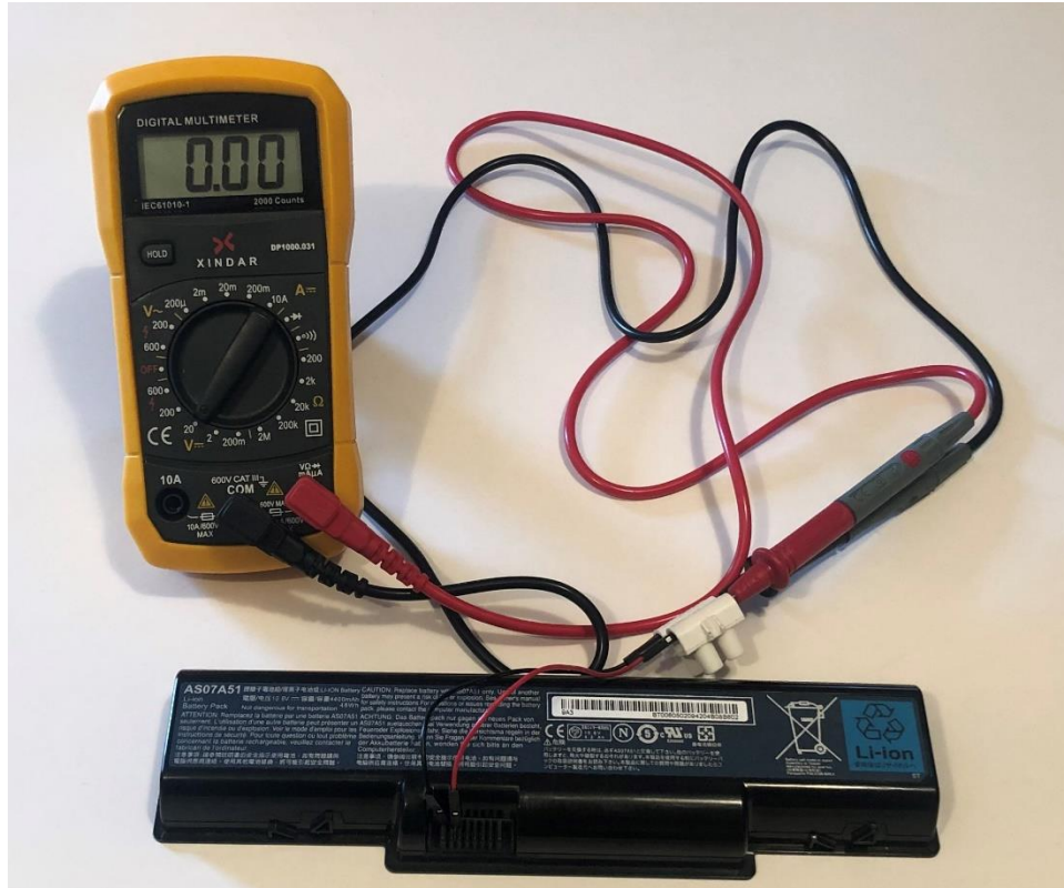
Figura 70: Toma de datos de la batería. (Elaboración propia)
