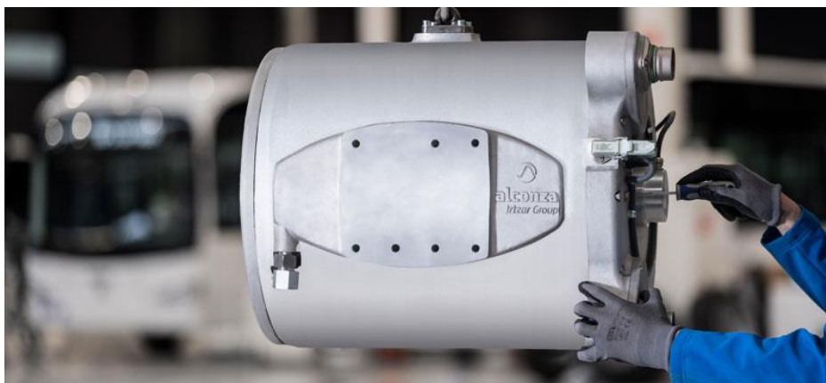
Figura 60: Motor síncrono de imanes permanentes Alconza. (Irizar Group, 2019)
