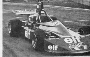
Ecco la nuova F.2 Elf-March. Il telaio è per ora un 752 adattato. Il motore Alpine è montato arretrato, con il serbatoio dell'olio davanti prima della centina dietro il pilota
