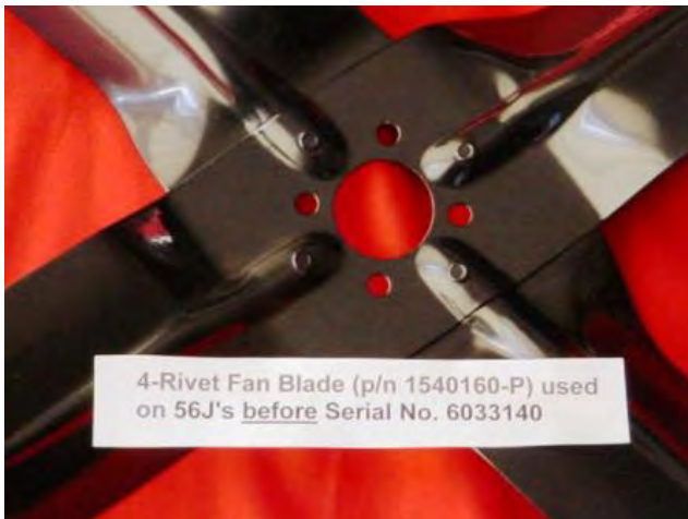
4 Rivet Fan Blade Part # 1540160-P
