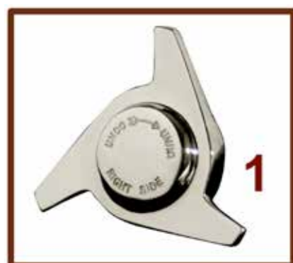
Bild 1. Vänstergängad "knackmutter" för bilens högra sida.
