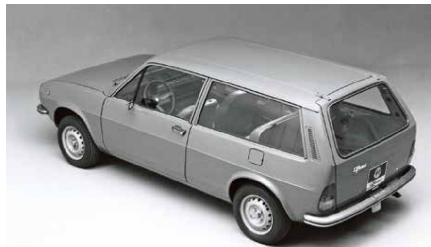
Här syns de långsgående vecken som förstärkte takplåten.
