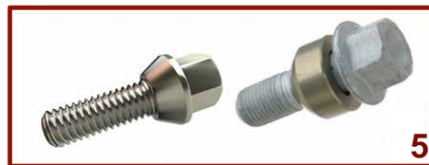
Bild 5. Fler och fler bilar utrustas med den högra typen av hjulskruv, med en lös kona som styr upp skruven i hålet. Skruvskallen verkar mot en plan yta, varför åtdragningsmomentet inte behövs för att övervinna krafterna orsakade av konan. Detta förbättrar möjligheten att dra skruven till korrekt förspänning.
