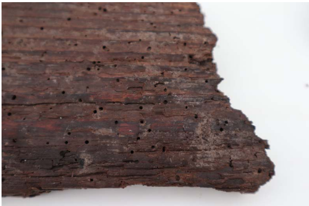
Figuur 47. Gorinchem, Knipsteeg 13-15: Detailopname van een sterk verweerd plankfragment met veel vraatsporen veroorzaakt door de houtwormkever.
