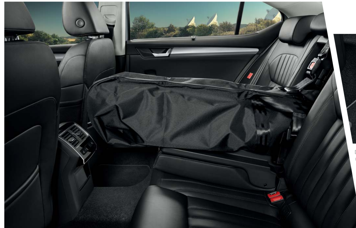
Sklopná zadní loketní opěra umožňuje vytvořit otvor mezi kabinou a zavazadlovým prostorem. Tudy pak jednoduše prostrčíte vyjímatelný vak Unibag určený pro bezpečné převážení lyží nebo snowboardu.
